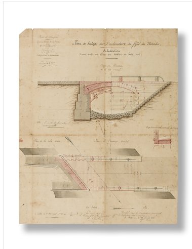
Pont de halage sur l'embouchure du fossé du Vannois. Substitution d'une voûte en pierre au tablier en bois, usé. 15 avril 1865.
