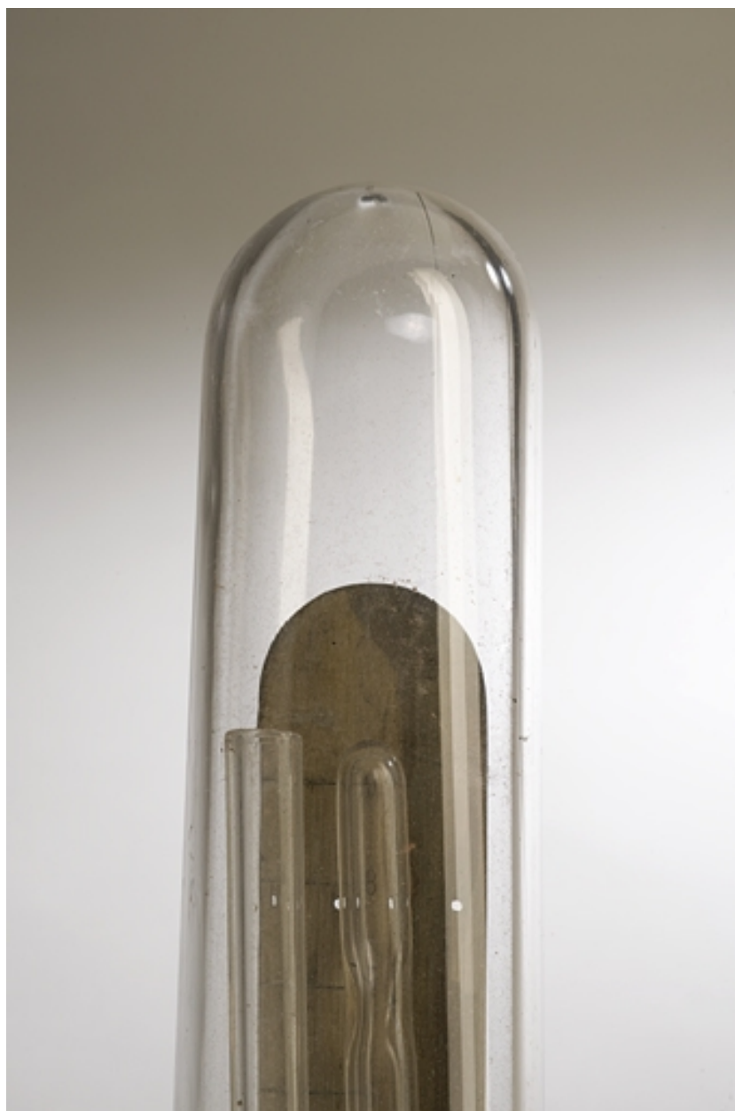
Grand manomètre : extrémités ouverte et fermée du baromètre contenu dans l'éprouvette.
