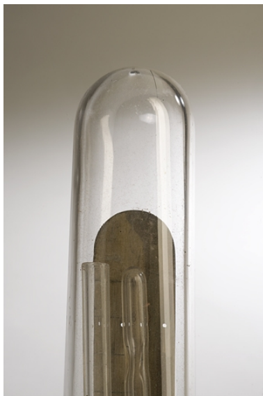
Grand manomètre : extrémités ouverte et fermée du baromètre contenu dans l'éprouvette. Phot. Marc Loukachine IVR43_20122500095NUC4A
