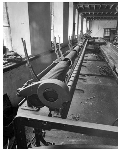
Ratelier du module de gauche. De gauche à droite, supports des cannelles, tambours cannelés et cylindres presseurs (surmontant les cylindres alimentaires non visibles). Phot. Yves Sancey IVR43_19943901488X
