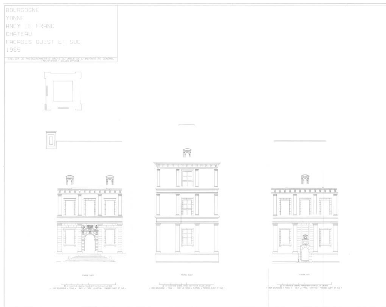
Façades ouest et sud, restitution photogrammétrique.
