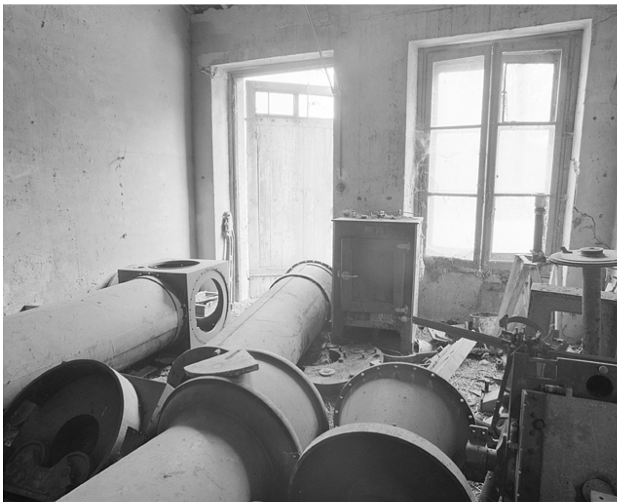
Vue d'ensemble des pièces démontées. De gauche à droite : tube objectif et cube central qui lui est fixé, embase du pivot horaire inférieur, tube oculaire, contrepoids et pivot horaire inférieur.
