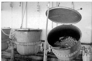
Conserverie Ménétre, atelier de fabrication (3) : marmites de première cuisson. Phot. Laurent Poupard IVR43_19893900626Z
