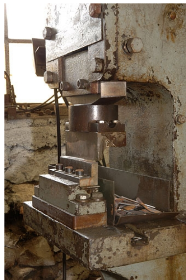
Détail de la cisaille gauche. Phot. Jérôme Mongreville IVR43_20057000078NUCA
