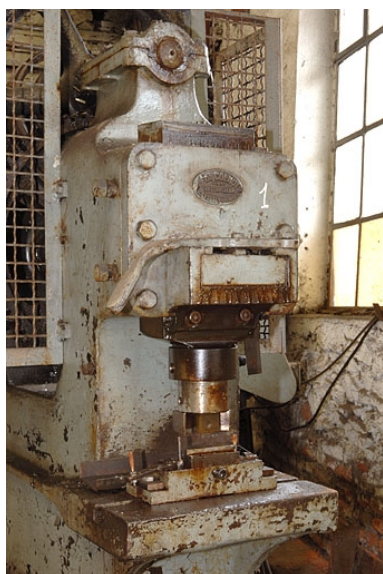
Détail de la cisaille droite. Phot. Jérôme Mongreville IVR43_20057000079NUCA
