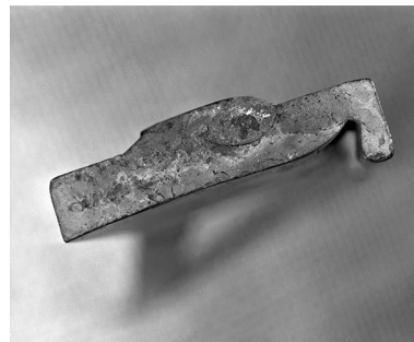
Profil d'un fer de forme servant à l'incrustation des motifs décoratifs sur le couvercle des tabatières. Phot. Jérôme Mongreville IVR43_20003901108X
