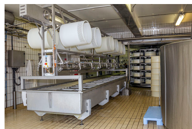
Installation de soutirage par pompe à caillé : le répartiteur. Les rehausses de moulage sont suspendues en partie haute du répartiteur. Phot. Yves Sancey IVR43_20132501469NUC2A
