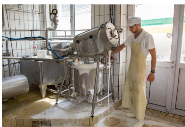
Nettoyage des installations : filtre à sérum.
