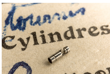
Cylindre. La lèvre d'entrée (la plus grande) est visible en avant-plan, celle de sortie (plus petite) à l'arrière-plan. Phot. Sonia Dourlot IVR43_20202500019NUC4A
