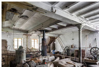
Rez-de-chaussée de l'atelier de fabrication. Au centre, arbre de la turbine. Phot. Jérôme Mongreville IVR43_20172501084NUC4A
