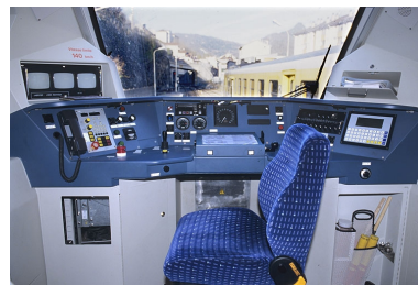
Intérieur : poste de conduite (extrémité côté Andelot-en-Montagne).
