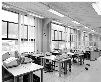
Bâtiment B, optique-lunetterie (1er étage) : machines à déborder. Phot. Yves Sancey IVR43_20033901021X
