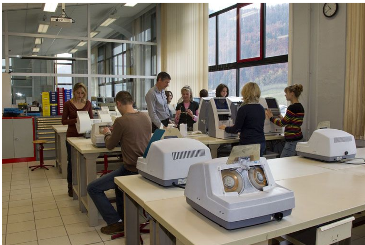
Bâtiment B, optique-lunetterie (1er étage) : ensemble de machines à déborder. Meuleuses MD2, d'Essilor.
