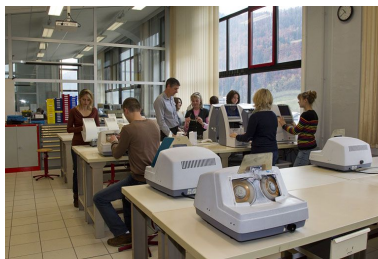
Bâtiment B, optique-lunetterie (1er étage) : ensemble de machines à déborder. Meuleuses MD2, d'Essilor. Phot. Yves Sancey IVR43_20123900084NUC2A
