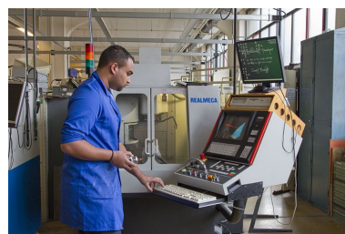
Bâtiment B, atelier de mécanique : machine à commande numérique (centre d'usinage 5 axes). Phot. Yves Sancey IVR43_20123900088NUC2A
