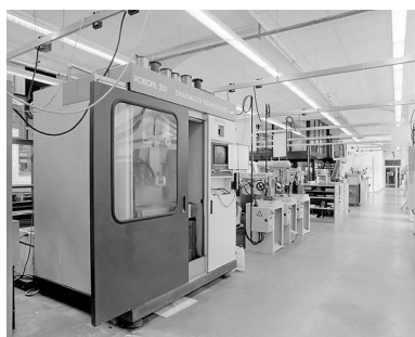
Bâtiment B, atelier de mécanique : machine d'usinage par électroérosion à fil. Machine Robofil 300, de la société Agie Charmilles. Phot. Yves Sancey IVR43_20033901034X
