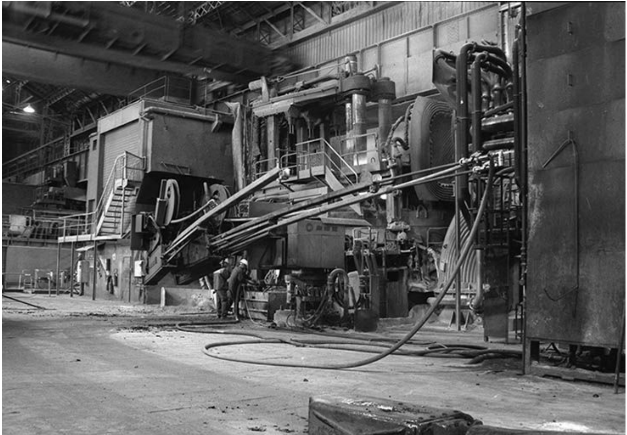
Le four électrique de 100 tonnes en activité.
