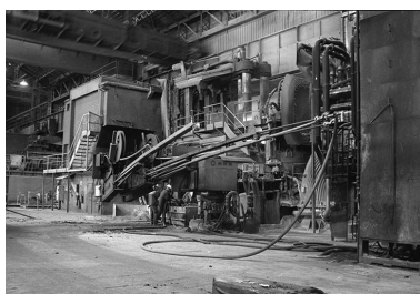
Le four électrique de 100 tonnes en activité. Phot. Frédéric Pillet IVR26_20007100472Z
