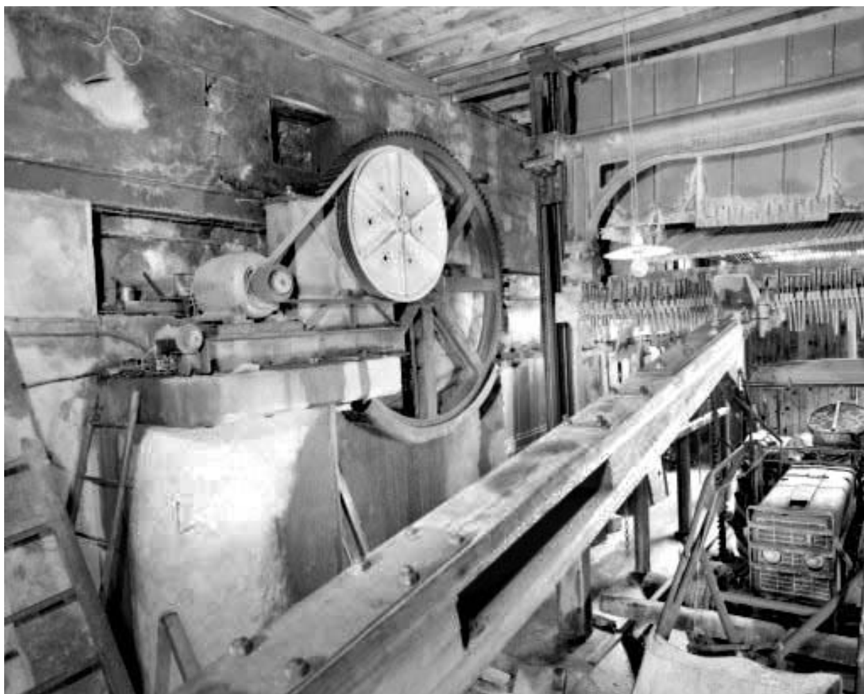
Noria : moteur et système d'entraînement.
