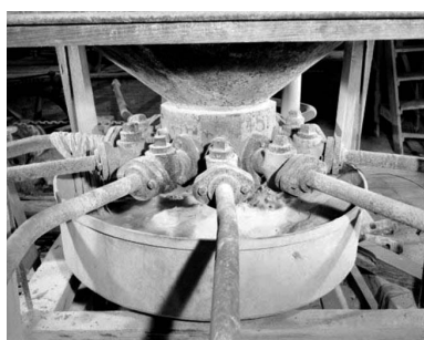
Système de distribution du mélange eau-sable : départ des conduites. Phot. Yves Sancey IVR43_19933900319X
