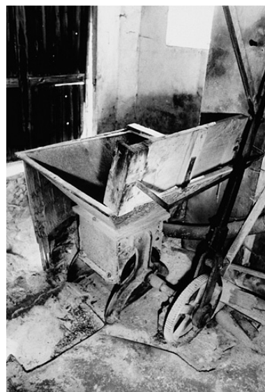
Doseur de sable, vu en plongée. Phot. Yves Sancey IVR43_19933900480ZA
