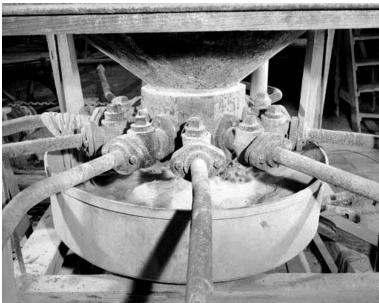
Système de distribution du mélange eau-sable : départ des conduites.
