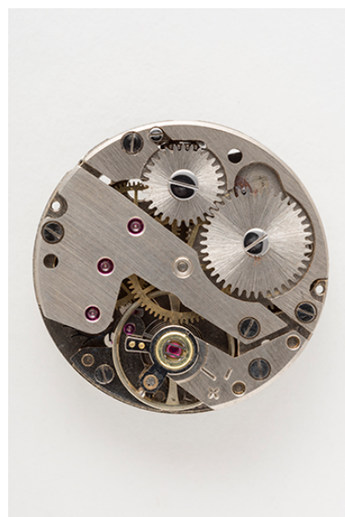
Mouvement de montre mécanique Cupillard 233-60. Phot. Sonia Dourlot IVR43_20152502561NUC4A
