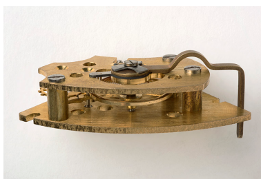
Echappement à chevilles et porte-échappement de la société Jeambrun Appareillages. Phot. Sonia Dourlot IVR43_20152502582NUC4A
