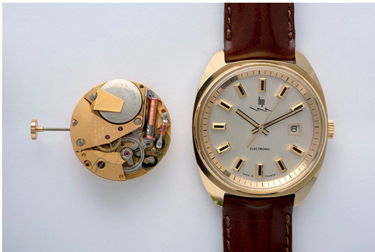
Montre-bracelet électromécanique de la gamme Lip Electronic (dite montre du Général de Gaulle), à côté d'un mouvement R 184.
