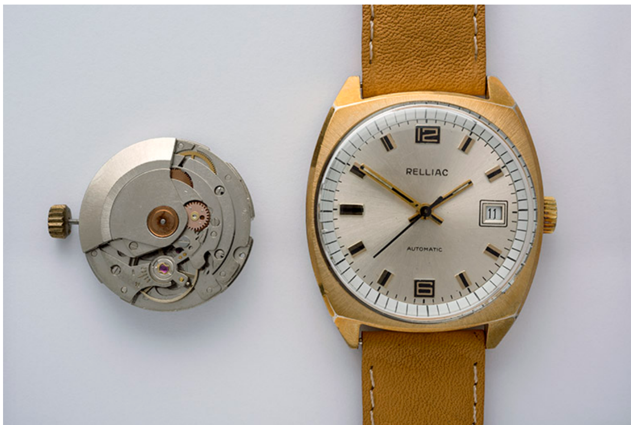
Montre-bracelet automatique Relliac, à côté d'un mouvement FE 4611.
