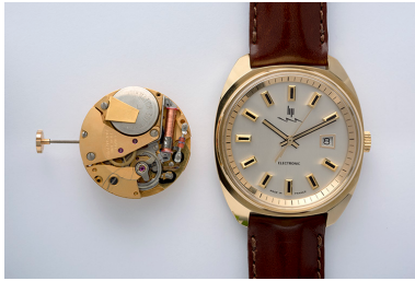
Montre-bracelet électromécanique de la gamme Lip Electronic (dite montre du Général de Gaulle), à côté d'un mouvement R 184. Phot. Sonia Dourlot IVR43_20152502586NUC4A
