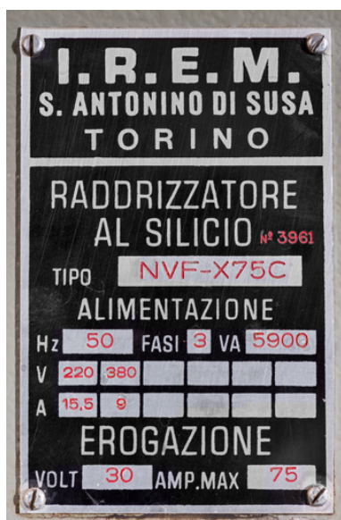
Redresseur IREM : plaque signalétique du constructeur. Phot. Pierre-Marie Barbe-Richaud IVR26_20238900445NUC4A
