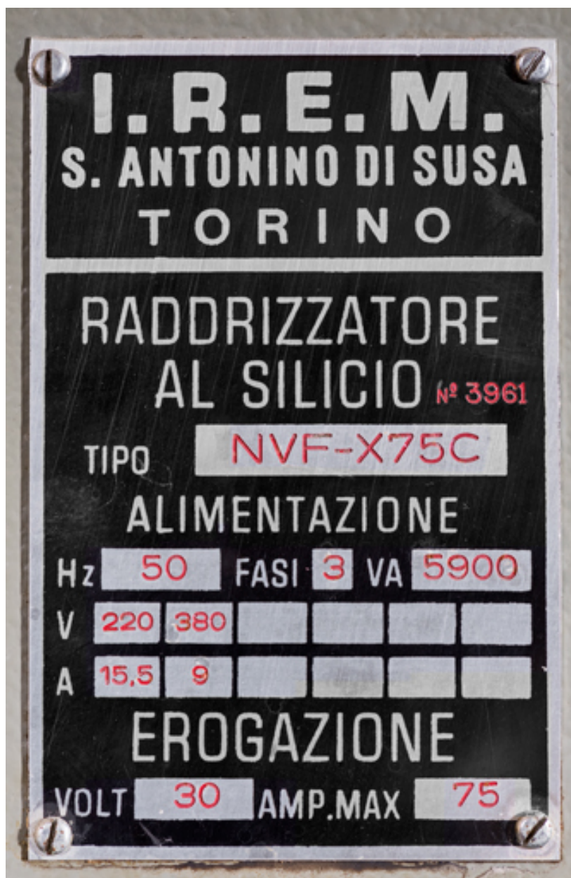
Redresseur IREM : plaque signalétique du constructeur.
