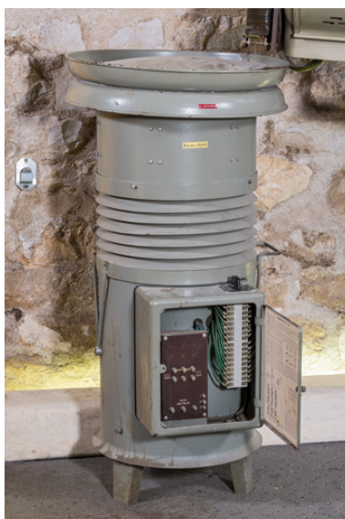
Redresseur IREM, porte ouverte. Phot. Pierre-Marie Barbe-Richaud IVR26_20238900443NUC4A
