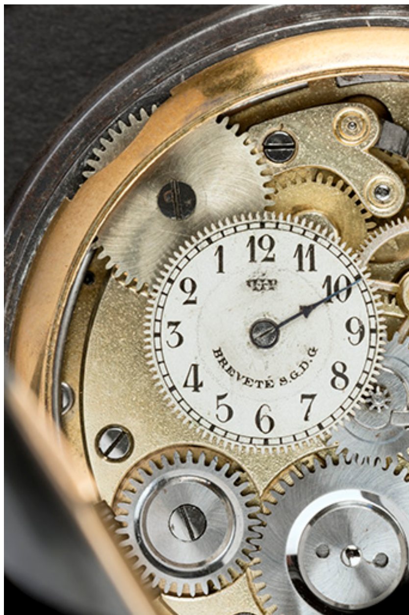
Mouvement : cadran de réglage du réveil.
