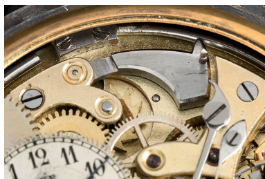
Mouvement : marteau et gong circulaire.
