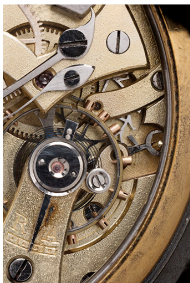
Mouvement : balancier, ancre et roue d'ancr.
