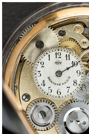
Mouvement : cadran de réglage du réveil.
