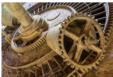
Détail de la partie supérieure de la turbine. Phot. Jérôme Mongreville IVR43_20152501166NUC4A
