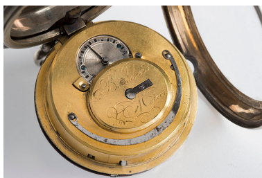
Platine supérieure, coq et raquette (système de réglage de l'avance / retard). Phot. Sonia Dourlot IVR43_20142501708NUC4A
