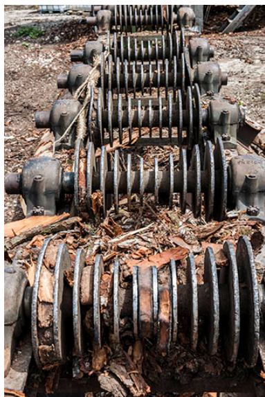
Détail des rouleaux d'entraînement. Phot. Jérôme Mongreville IVR43_20152501474NUC4A
