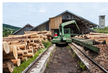
Chariot de transport de grumes, sur rails. Phot. Jérôme Mongreville IVR43_20152501476NUC4A
