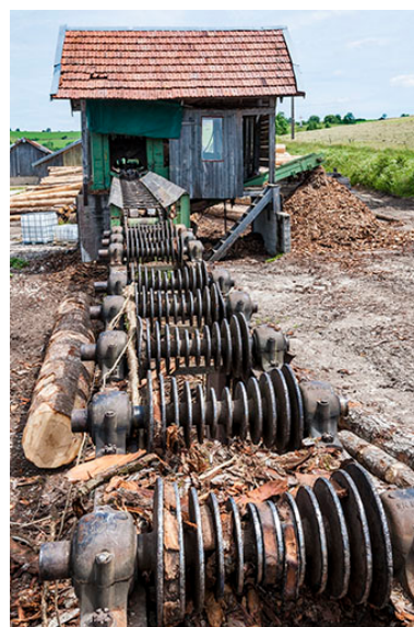
Rouleaux d'entraînement du poste d'écorçage. Phot. Jérôme Mongreville IVR43_20152501475NUC4A
