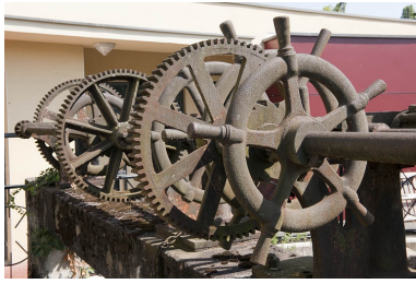
Système de vannage du bief de dérivation. Détails de volants et engrenages.
