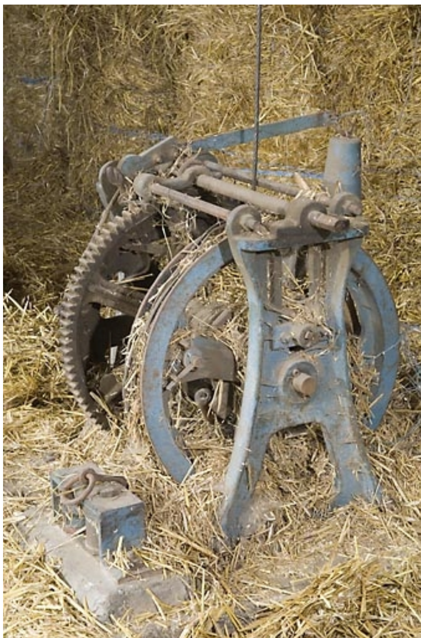
Grange haute : treuil de la déchargeuse.
