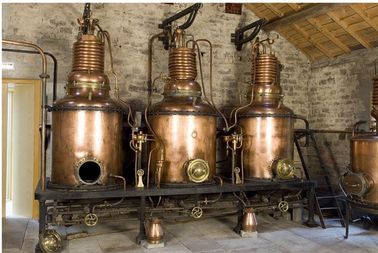
Trois alambics à vapeur (1000-1200 l) provenant de la distillerie Lemer cier (Prédurupt).
