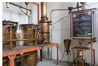
Salle de distillation. Alambics, colonne de rectification et réfrigérant. Phot. Jérôme Mongreville IVR43_20067000801NUCA
