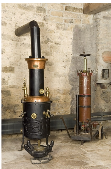
Chaudière des Ets Chatillon (pour l'entretien des tonneaux de fermentation) et filtreuse Simoneton. Phot. Jérôme Mongreville IVR43_20067000811NUCA
