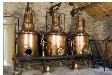
Trois alambics à vapeur (1000-1200 l) provenant de la distillerie Lemerrier (Prédurupt). Phot. Jérôme Mongreville IVR43_20067000809NUCA
