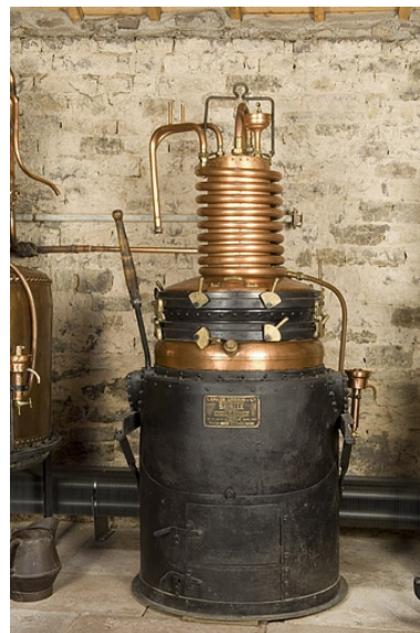
Alambic à vapeur Lepage, Urbain et Cie, provenant de la distillerie Lemerrier (Prédurupt). Phot. Jérôme Mongreville IVR43_20067000810NUCA
