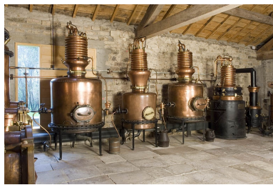
Trois alambics à vapeur provenant de la distillerie Lemerrier (Prédurupt), et alambic Lepage, Urbain et Cie. Phot. Jérôme Mongreville IVR43_20067000812NUCA
