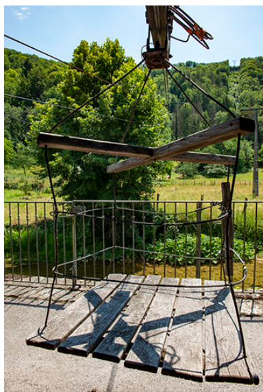
2020. Vue du treuil du transporteur automatique par câbles. Phot. Jérôme Mongreville IVR43_20203900074NUC4A
