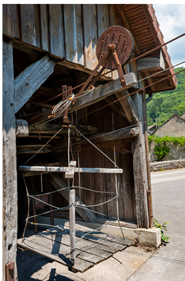
2020. Transporteur automatique par câbles : vue de la cage de dépôt des bidons. Phot. Jérôme Mongreville IVR43_20203900075NUC4A
