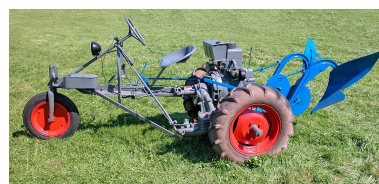
Kiva à moteur à essence Chaise, équipée d'une charrue à deux socs. Phot. Laurent Poupard IVR43_20193900098NUC2A
