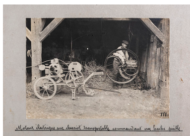
Moteur électrique [japy] sur chariot transportable commandant un hache paille, 1ère moitié 20e siècle. Phot. Sonia Dourlot IVR43_20209000060NUC4A
