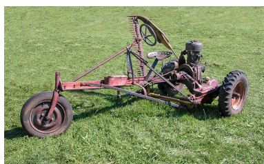
Kiva à moteur à essence Chaise, équipée de sa barre de coupe. Phot. Laurent Poupard IVR43_20193900097NUC2A
