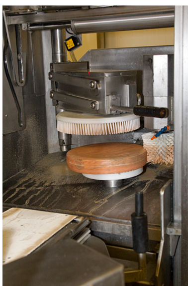
Fabrication du morbier : installation de salage et brossage des meules (robot). Phot. Yves Sancey IVR43_20132500357NUC2A
