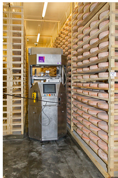
Fabrication du morbier : robot de soins (salage et retournement des meules) JNJ Automation.
