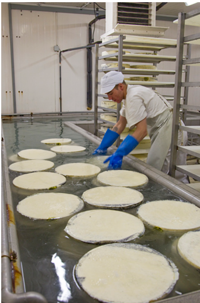
Fabrication du morbier : trempage des meules dans la saumure.
