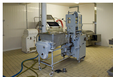
Fabrication du beurre : la moulineuse-empaqueteuse. Phot. Yves Sancey IVR43_20132500333NUC2A
