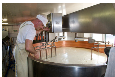
Fabrication du comté : examen du tranchage du caillé dans la deuxième cuve. Phot. Yves Sancey IVR43_20132500318NUC2A
