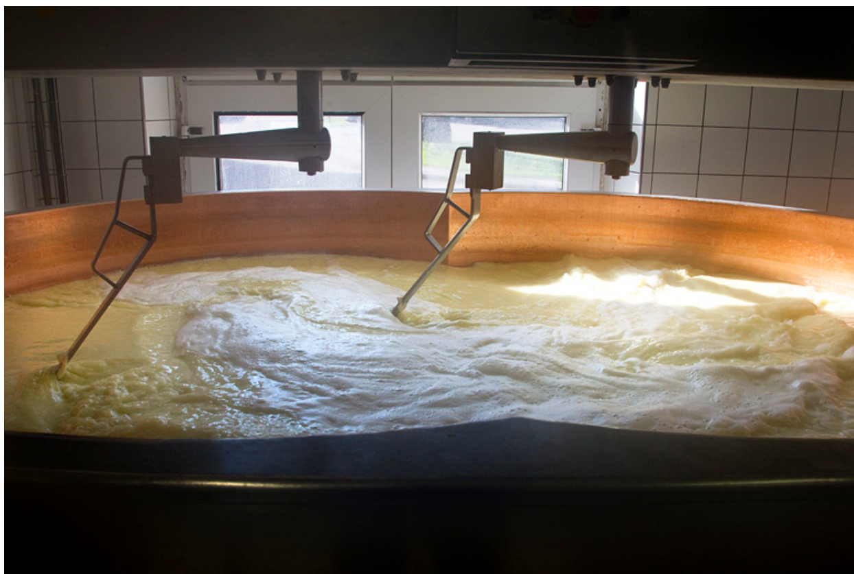
Fabrication du comté : brassage de la première cuve.
