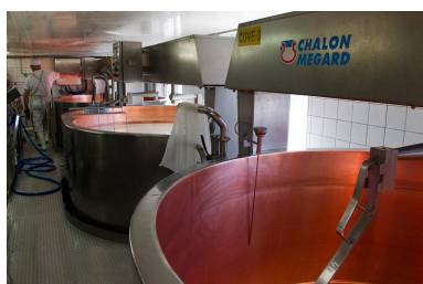
Fabrication du comté : nettoyage de la première cuve et caillé dans la deuxième. Phot. Yves Sancey
