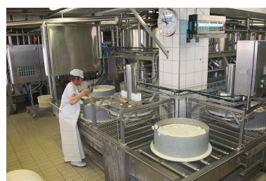
Fabrication du comté : enlèvement de l'écume du moule rempli de caillé et mise en place de la plaque de caséine.
