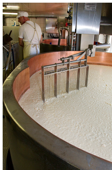
Fabrication du comté : caillé dans la deuxième cuve. Phot. Yves Sancey IVR43_20132500320NUC2A
