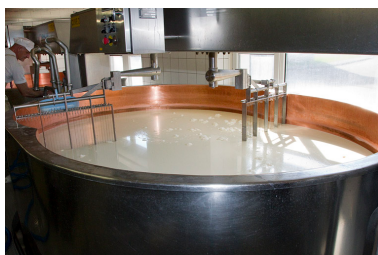
Fabrication du comté : deuxième cuve, équipée des tranche-caillé. Phot. Yves Sancey IVR43_20132500316NUC2A
