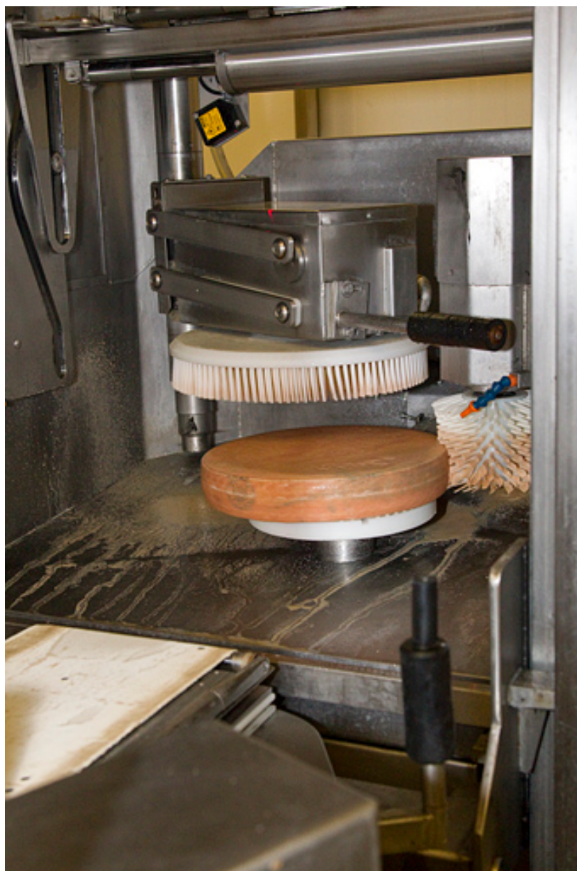
Fabrication du morbier : installation de salage et brossage des meules (robot).
