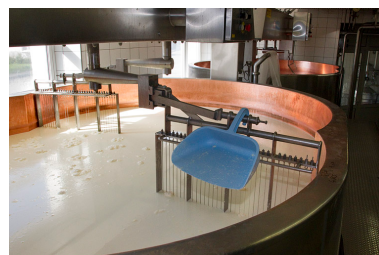
Fabrication du comté : deuxième cuve, avec tranche-caillé et pelle. Phot. Yves Sancey IVR43_20132500315NUC2A
