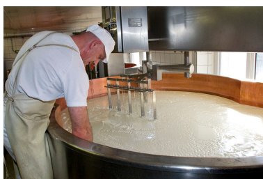
Fabrication du comté : examen du tranchage du caillé dans la deuxième cuve. Phot. Yves Sancey IVR43_20132500319NUC2A
