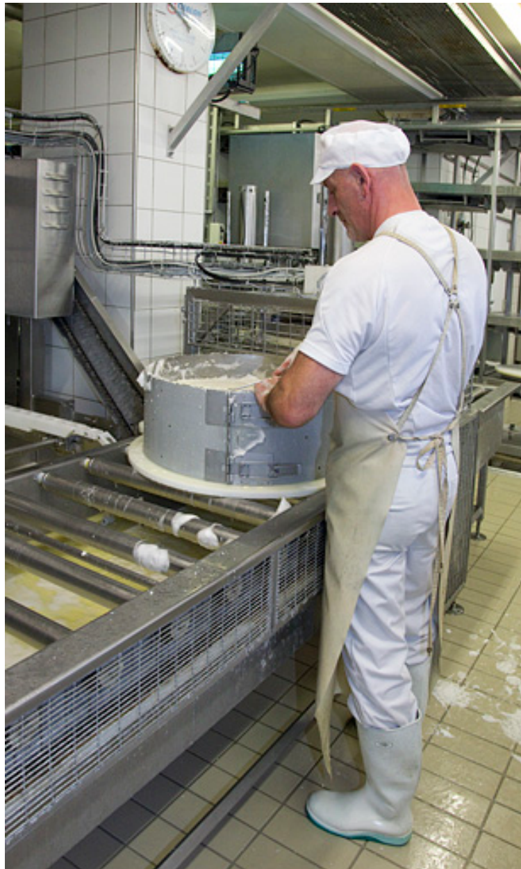
Fabrication du comté : enlèvement de l'écume du moule rempli de caillé.
