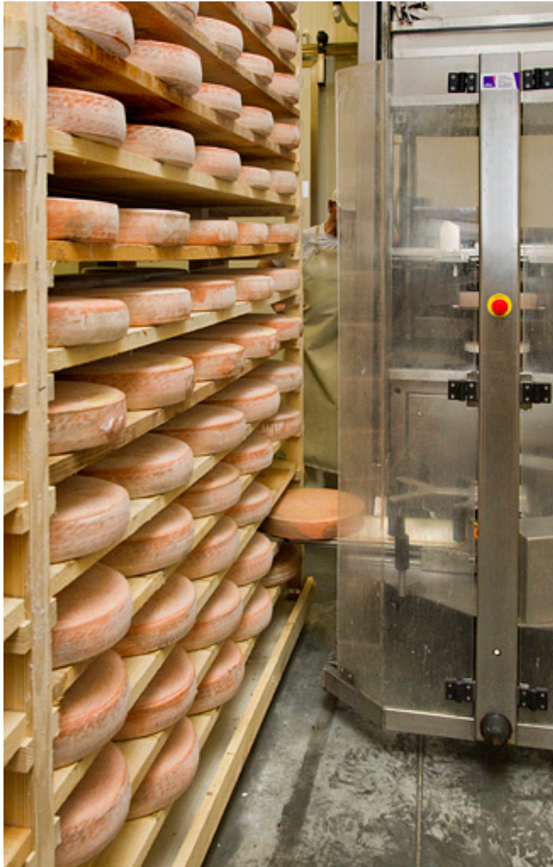
Fabrication du morbier : robot prenant une meule.
