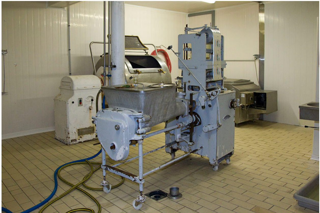
Fabrication du beurre : la moulreuse-empaqueteuse.
