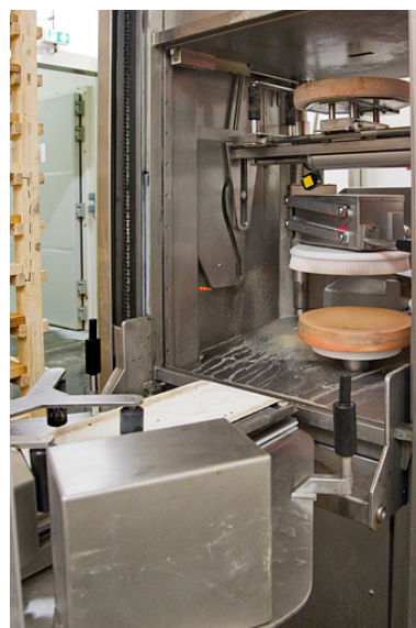
Fabrication du morbier : zone de travail du robot de soins. Phot. Yves Sancey IVR43_20132500349NUC2A
