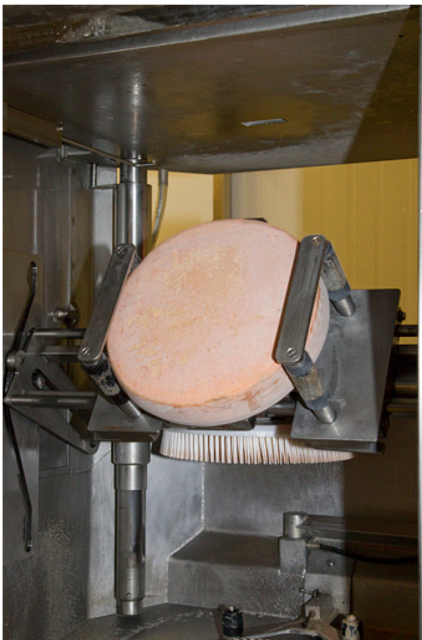
Fabrication du morbier : retournement d'une meule (robot).
