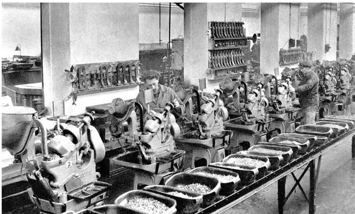
Machines automatiques à tarauder les écrous.
