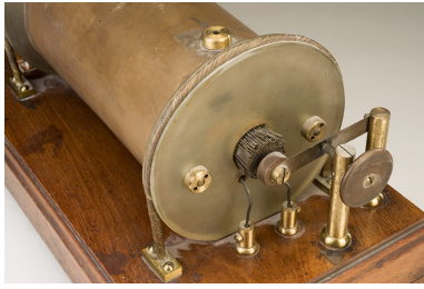
Détail : le trembleur. Phot. Marc Loukachine IVR43_20122500063NUC4A
