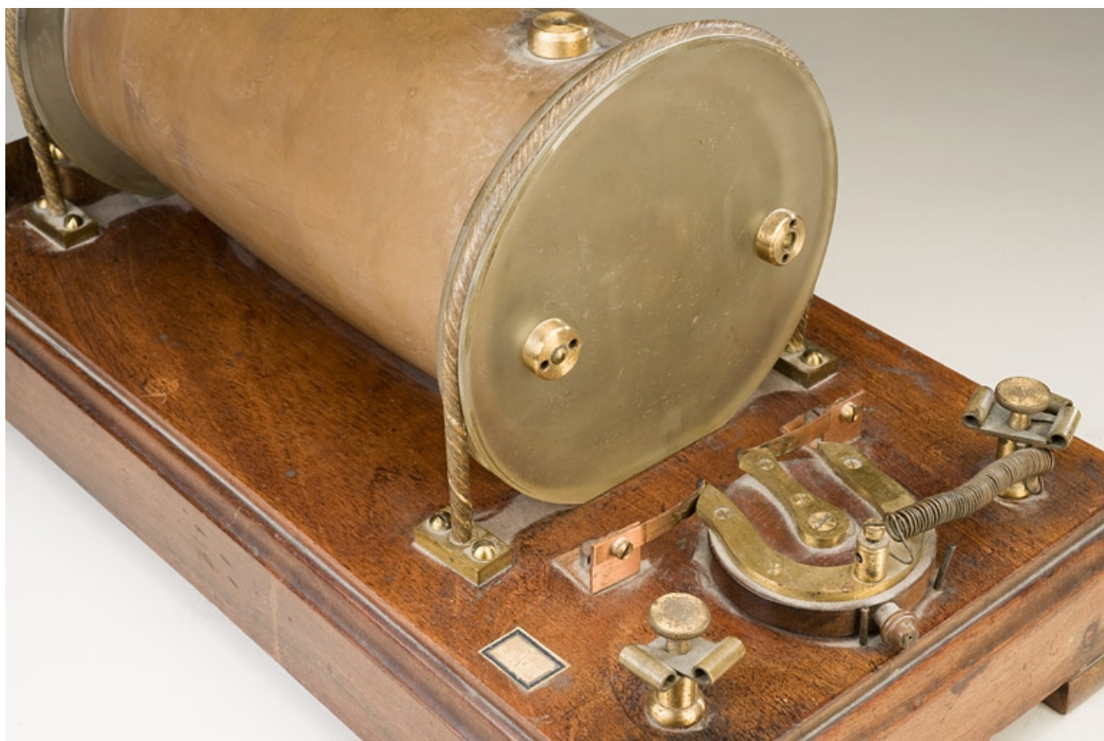
Détail : le commutateur de Bertin.
