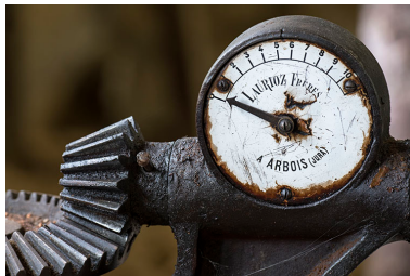
Usine : manomètre de la commande de la turbine Laurioz. Phot. Sonia Dourlot IVR43_20172500029NUC4A
