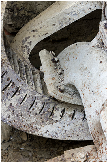
Usine : arrivée d'eau sur les aubes de la turbine. Phot. Sonia Dourlot IVR43_20172500034NUC4A
