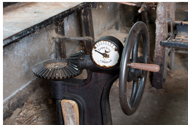
Usine : commande de la turbine Laurioz. Phot. Sonia Dourlot IVR43_20172500028NUC4A
