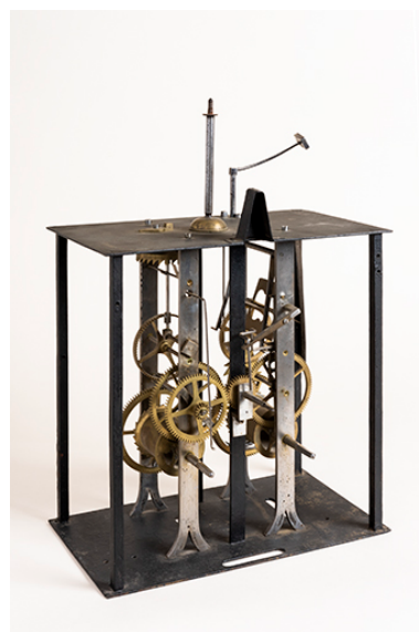
Mouvement d'horloge comtoise (mouvement "cage fer"), 19e siècle. Phot. Sonia Dourlot IVR43_20182501638NUC4A
