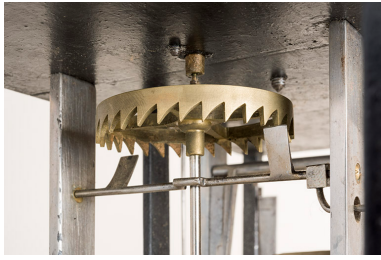
Mouvement d'horloge comtoise, 19e siècle : échappement à verge et roue de rencontre.
