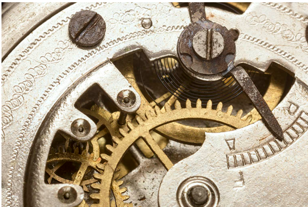
Mouvement : détail, avec la roue d'ancre à l'arrière-plan à gauche.
