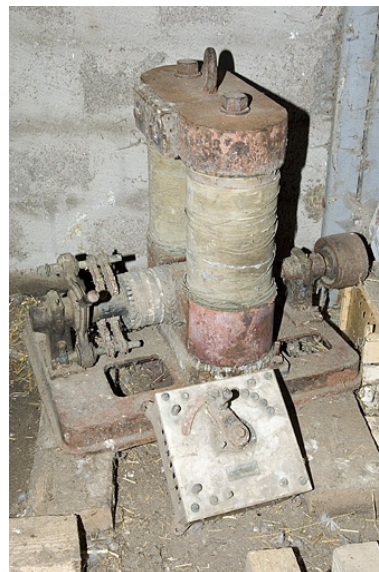
Moteur électrique Edison et tableau électrique. Phot. Jérôme Mongreville IVR43_20067000661NUCA
