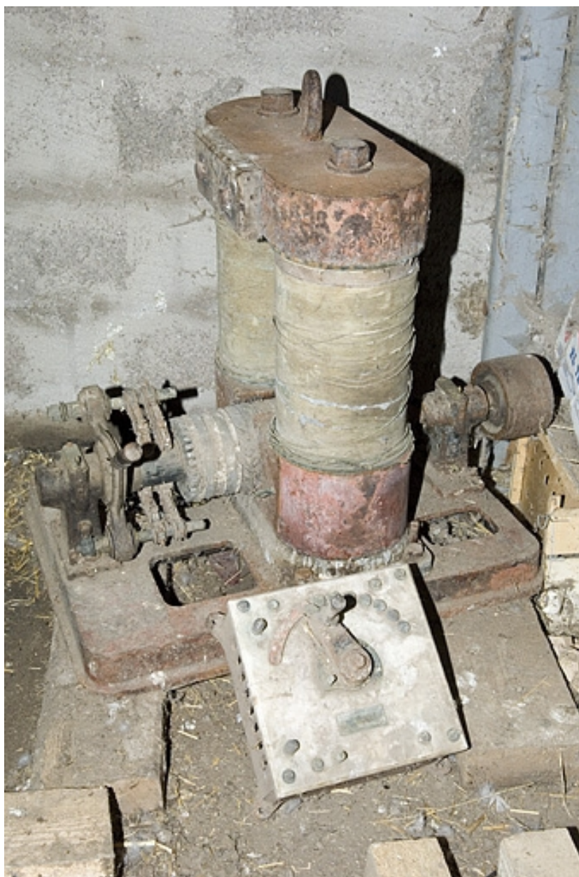
Moteur électrique Edison et tableau électrique.
