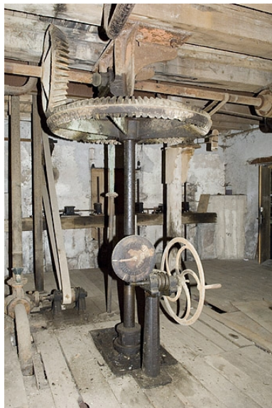
Système de transmission à l'aplomb de la turbine Goulut-Borne. Phot. Jérôme Mongreville IVR43_20067000657NUCA
