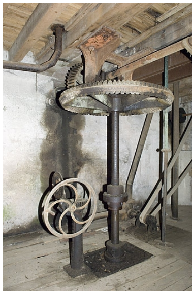
Système de transmission à l'aplomb de la turbine Goulut-Borne. Vue de côté. Phot. Jérôme Mongreville IVR43_20067000659NUCA
