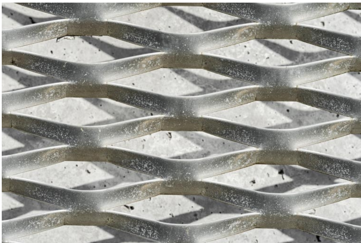
Résille métallique : détail.
