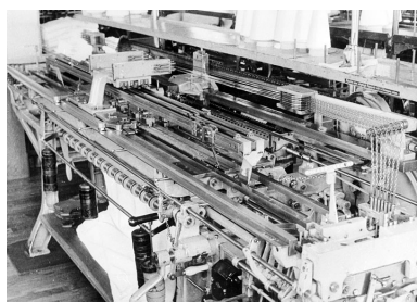
Machine à tricoter en panneau (marque Stoll, type Lifado). Phot. Yves Sancey IVR43_20009000919X
