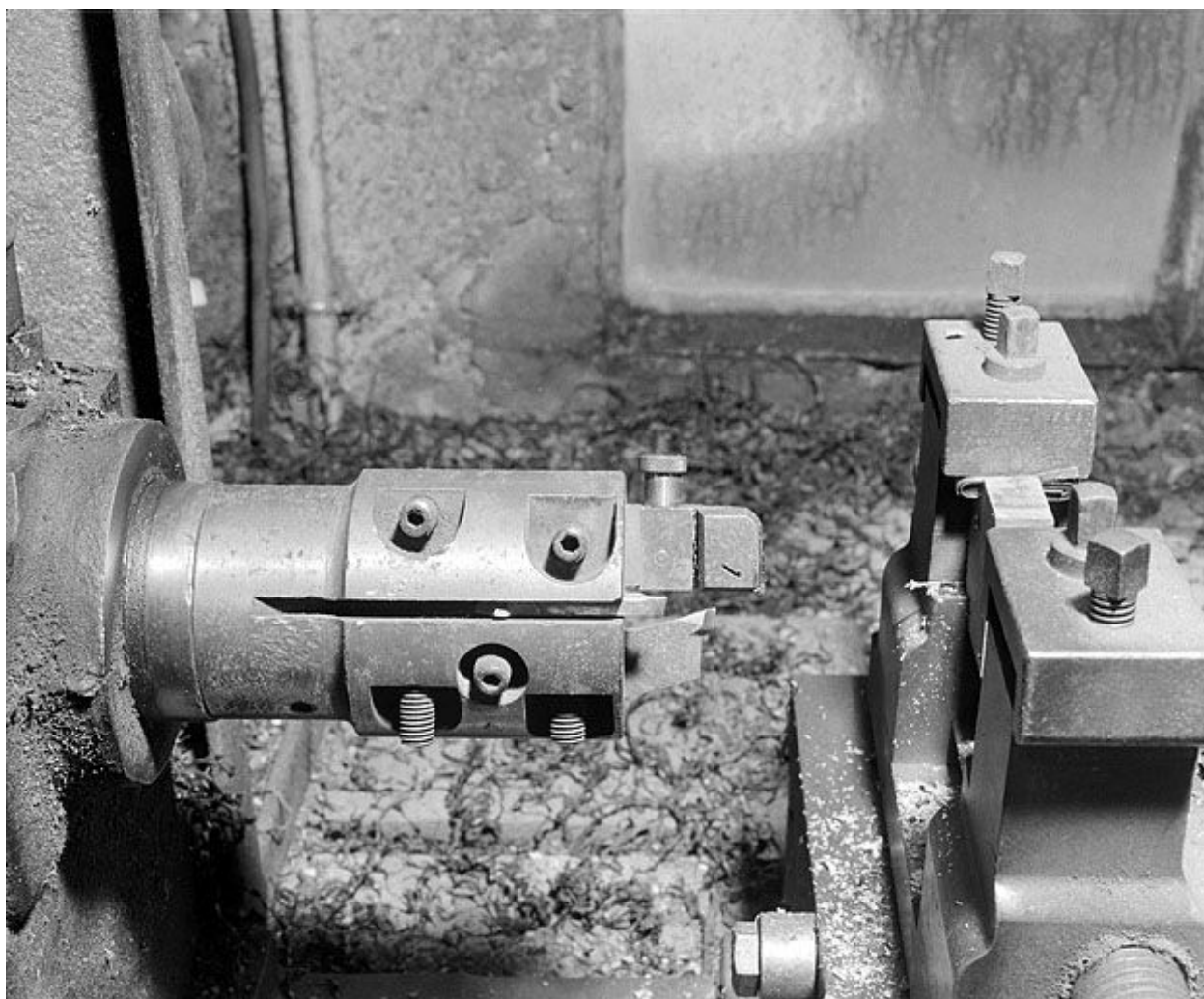
Détail du mandrin porte-outils (après rotation d'un quart de tour).
