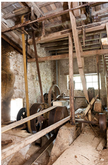
Vue d'ensemble de l'étage de soubassement. Système de transmission de la turbine hydraulique. Phot. Jérôme Mongreville IVR43_20152501806NUC4A
