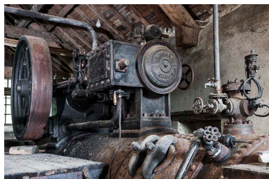
Volant d'inertie et cylindre de la machine à vapeur. Phot. Jérôme Mongreville IVR43_20152501816NUC4A
