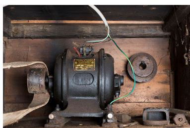
Atelier : moteur de 0,5 ch des Ateliers d'Orléans de la Compagnie générale d'Electricité (type L05 3 PH n° 30532). Phot. Sonia Dourlot IVR43_20172500791NUC4A
