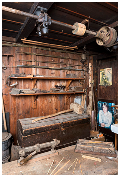
Atelier : établi, transmission, stockage des barres métalliques au mur. Phot. Sonia Dourlot IVR43_20172500784NUC4A
