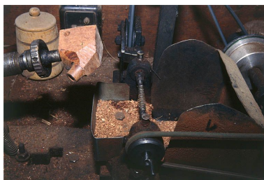
Partie gauche : détail du support de l'ébauchon. A droite, arbre cranté horizontal faisant office de fraise. Phot. Jérôme Mongreville IVR43_20003901024ZA
