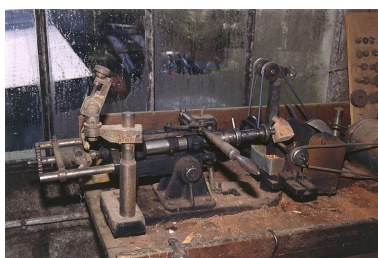
Vue d'ensemble de la partie gauche : guide et support de l'ébauchon. Phot. Jérôme Mongreville IVR43_20003901026ZA
