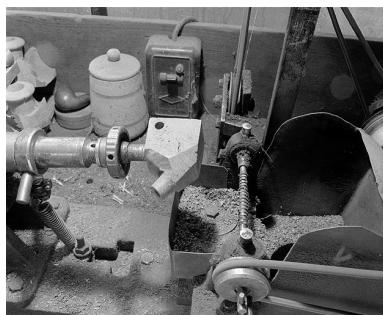
Partie gauche : détail du support de l'ébauchon. A droite, arbre cranté horizontal faisant office de fraise. Phot. Jérôme Mongreville IVR43_20003901023X
