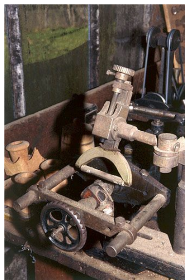
Partie gauche : détail du guide et du modèle. Phot. Jérôme Mongreville IVR43_20003901029ZA
