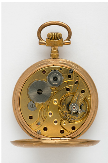
Mouvement Parrenin 18 lignes. Phot. Sonia Dourlot IVR43_20162500680NUC4A
