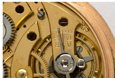
Mouvement : initiales du fabricant près du pont de balancier. Phot. Sonia Dourlot IVR43_20162500683NUC4A
