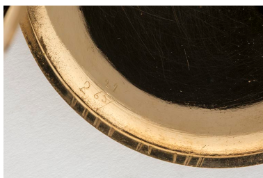
Inscription de rhabillage manuscrite gravée dans le fond et marques d'appariements sur la tranche. Phot. Sonia Dourlot IVR43_20162500682NUC4A
