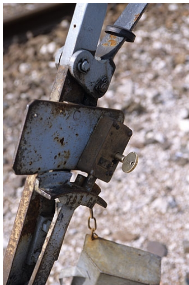
Levier de manoeuvre enclenché de l'appareil de voie C : détail de la serrure et de sa clef.
