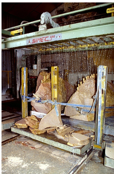
Châssis multilames Simec : vue de détail de trois quarts gauche. Phot. Yves Sancey IVR43_19973901695ZA
