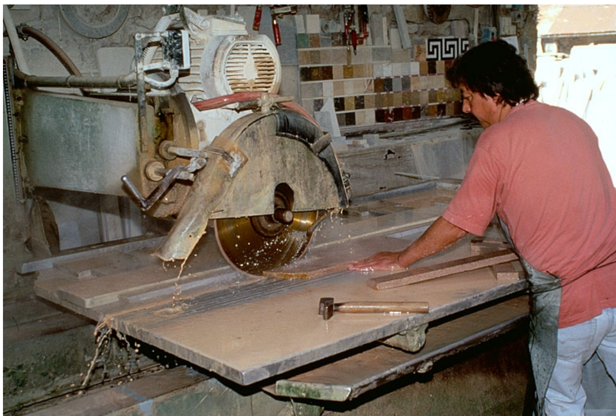
Débitage de plinthes en marbre de Balanod.
