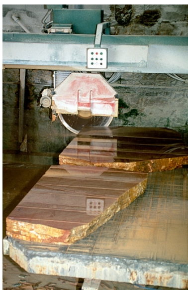
Débiteuse Gregori en cours de sciage : vue de détail. Phot. Yves Sancey IVR43_19973901734ZA
