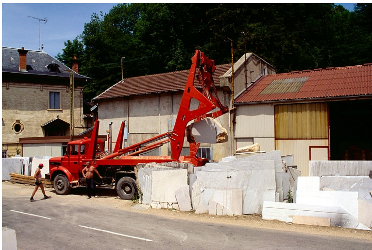
Déchargement d'un bloc de marbre de Balanod.
