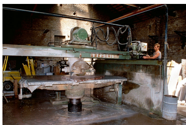
2e débiteuse Gregori en cours de sciage, avec ouvrier. Phot. Yves Sancey IVR43_19973901724ZA
