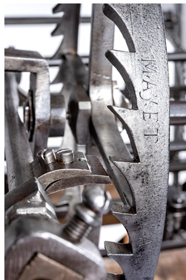
Inscription sur la roue d'échappement : nom du fabricant.
