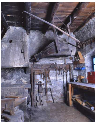
Intérieur de la forge, le soufflet et les outils. Phot. Jérôme Mongreville IVR43_19943900814XA
