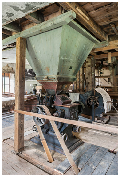
Broyeur à cylindres Goulut-Borne. Phot. Jérôme Mongreville IVR43_20142501167NUC4A
