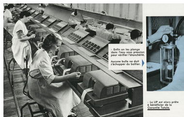
Contrôle d'étanchéité, photogr., 1956. IVR43_20182500219NUC2A
