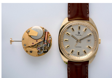
Montre-bracelet électromécanique dite Lip Electronic, à côté d'un mouvement Lip R 184 vu côté ponts. Phot. Sonia Dourlot IVR43_20152502586NUC4A
