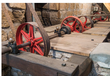
Arbre de transmission et poulies de renvoi.
