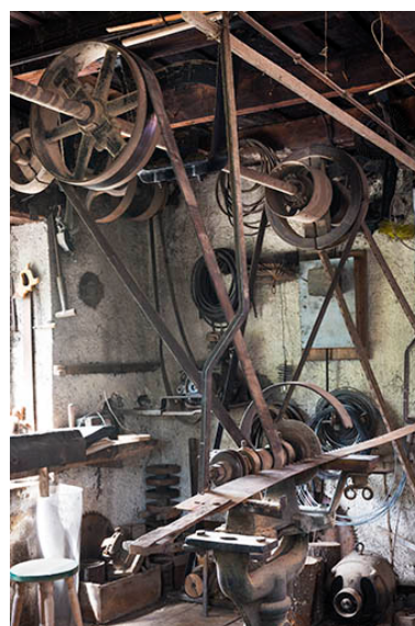
Affûteuse avec son mécanisme de transmission.
