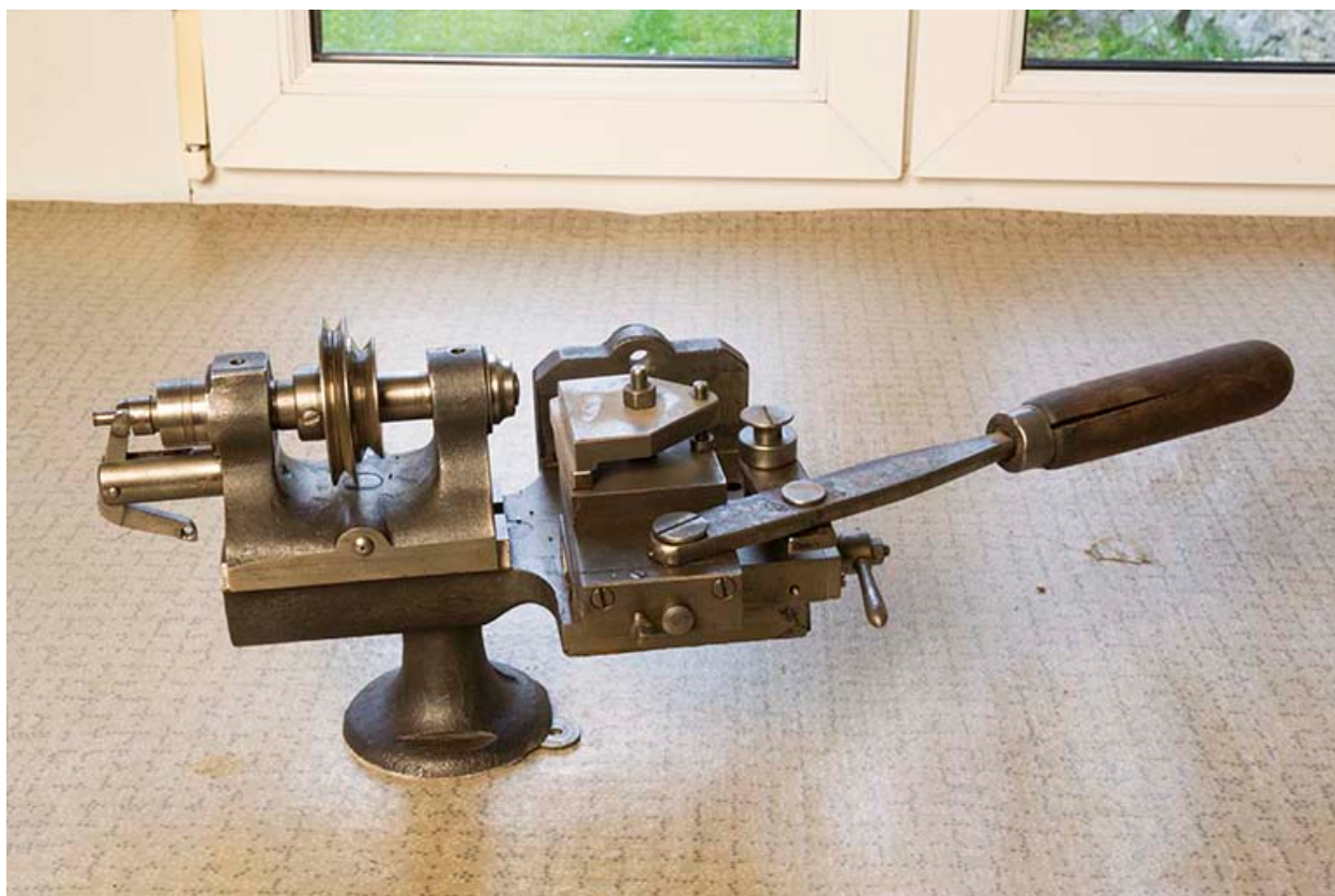
Exemple de production de l'atelier : machine à tamponner (insérer les tampons dans le cylindre).
