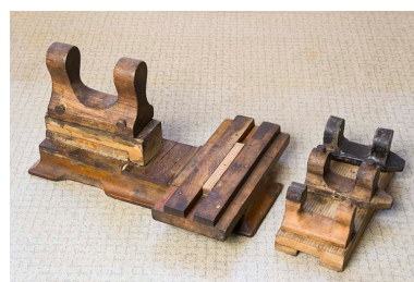
Exemple de production de l'atelier : modèle de fonderie en bois pour la fabrication d'une machine à pivoter. Phot. Yves Sancey IVR43_20132501945NUC2A
