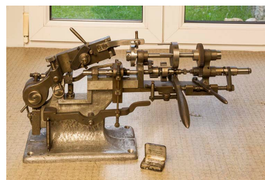
Exemple de production de l'atelier : machine à fabriquer les tire-neufs pour dentiste.
