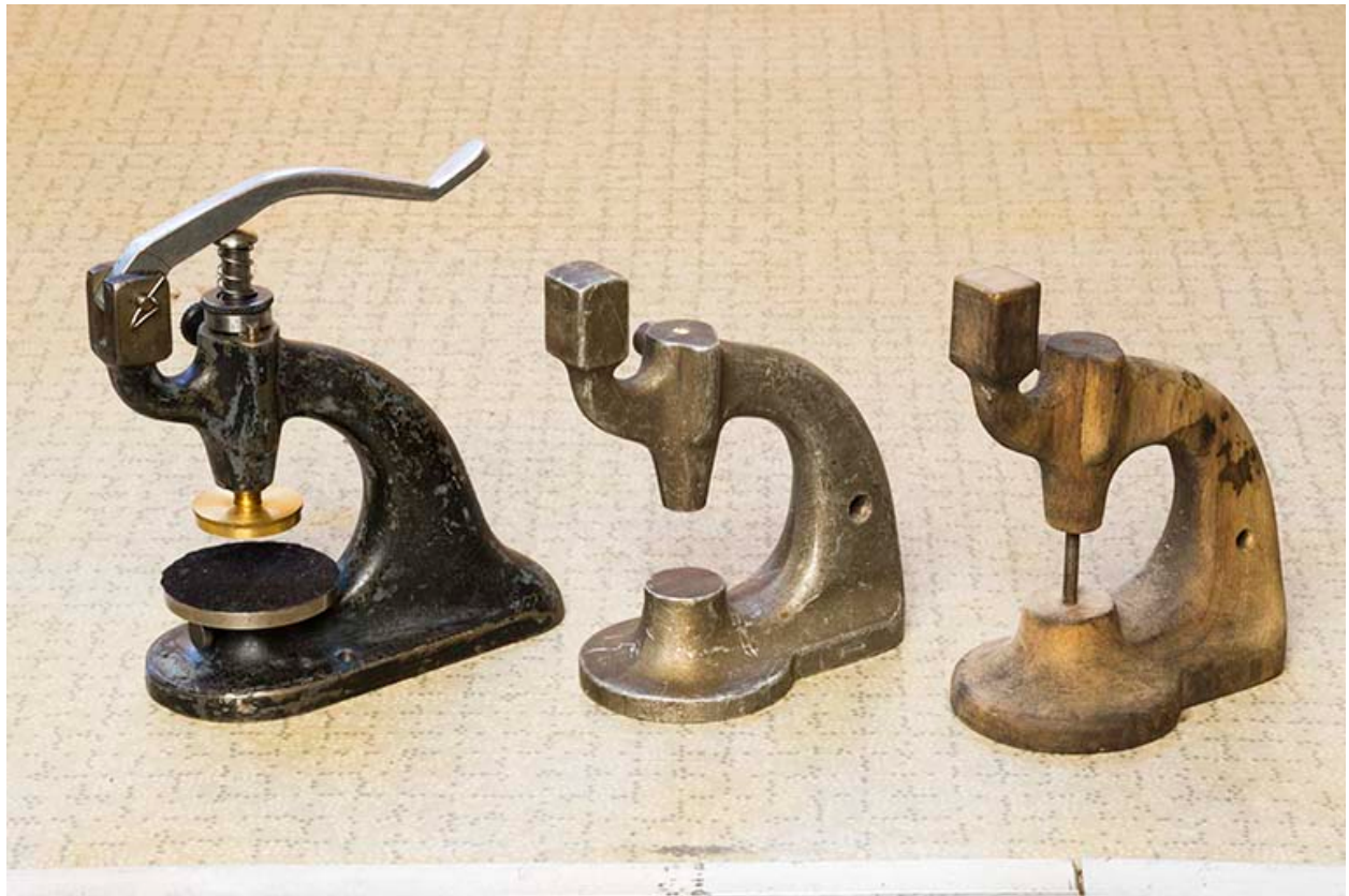
Exemple de production de l'atelier : modèles de fonderie pour la fabrication d'une potence à chasser les rubis et potence achevée.
