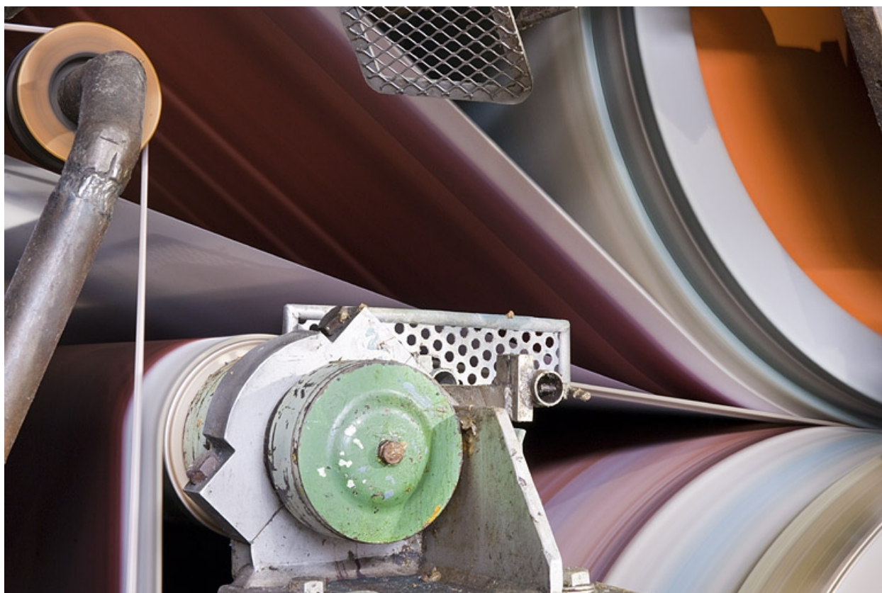
Usine de pâte à papier Paravicini-Maillard, actuellement Papeterie de Mandeure, Mandeure : passage de la feuille de papier entre les cylindres de pressage et d'égouttage.
