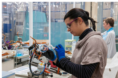
Isolation manuelle des barres de cuivre. Phot. Jérôme Mongreville IVR43_20162500180NUC4A
