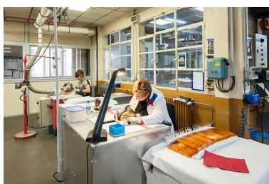
Isolation semi-automatique des barres de cuivre. Phot. Jérôme Mongreville IVR43_20162500179NUC4A
