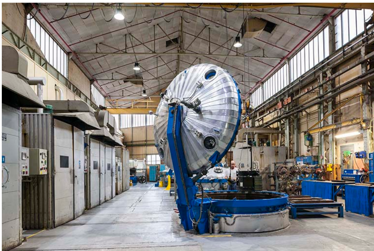
Atelier d'imprégnation (autoclave ouvert).
