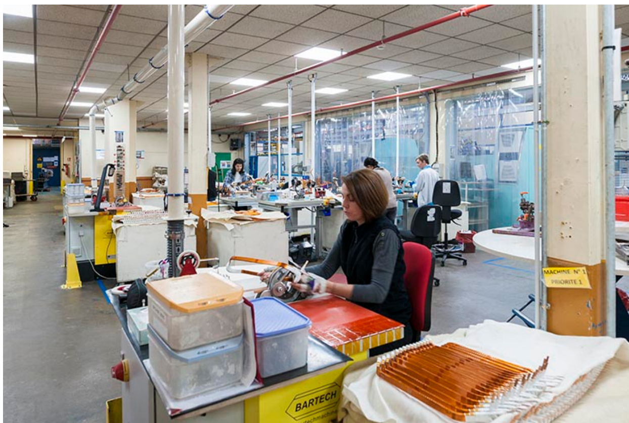
Isolation semi-automatique des barres de cuivre.
