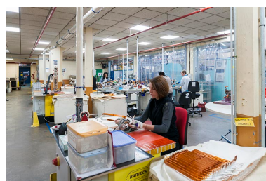
Isolation semi-automatique des barres de cuivre. Phot. Jérôme Mongreville IVR43_20162500178NUC4A
