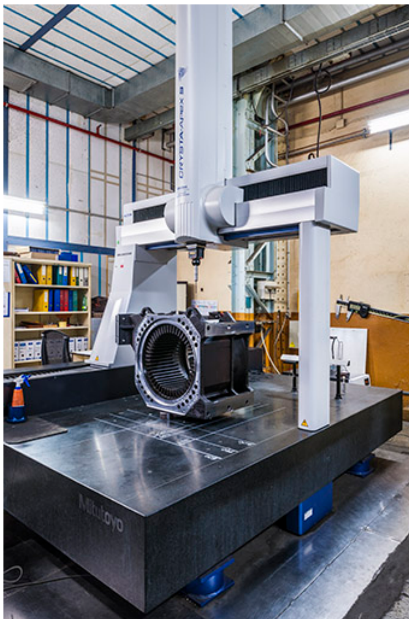
Contrôle tridimensionnel sur marbre.
