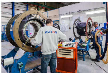
Atelier de bobinage. Montage des barres de cuivre sur les stators. Phot. Jérôme Mongreville IVR43_20162500168NUC4A
