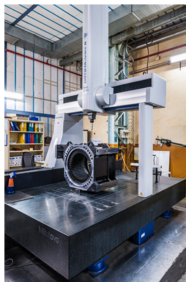
Contrôle tridimensionnel sur marbre. Phot. Jérôme Mongreville IVR43_20162500176NUC4A
