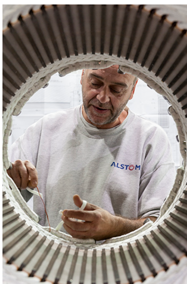
Atelier de bobinage. Montage des barres de cuivre. Phot. Jérôme Mongreville IVR43_20162500167NUC4A
