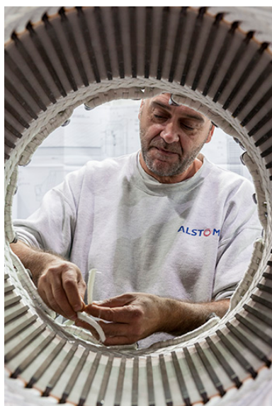
Atelier de bobinage. Montage des barres de cuivre. Phot. Jérôme Mongreville IVR43_20162500165NUC4A
