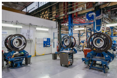
Atelier de bobinage. Equipement des stators. Phot. Jérôme Mongreville IVR43_20162500159NUC4A
