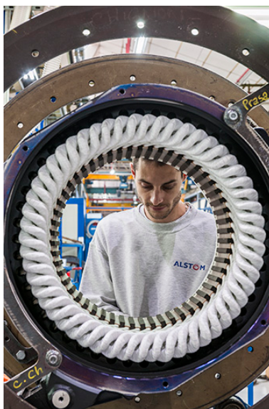
Atelier de bobinage. Montage des barres de cuivre sur un stator. Phot. Jérôme Mongreville IVR43_20162500161NUC4A
