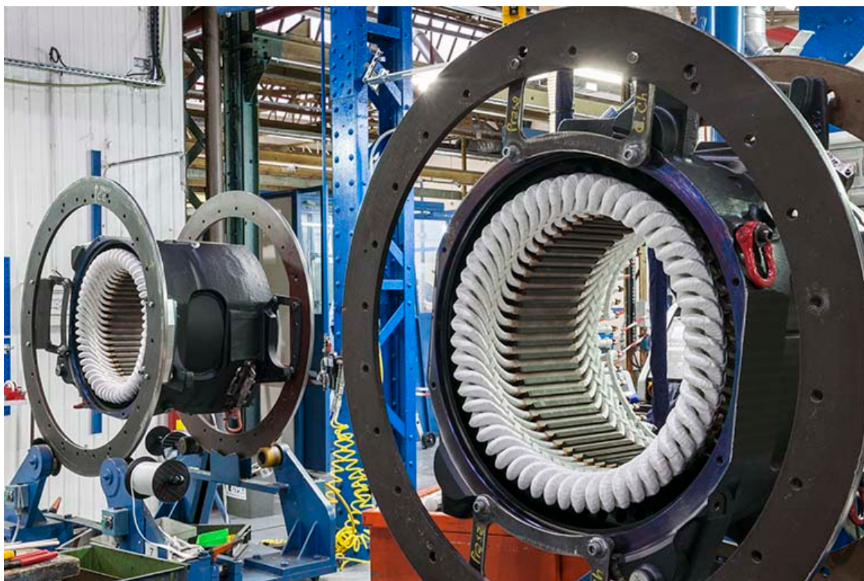
Atelier de bobinage. Stators équipés de barres de cuivre.
