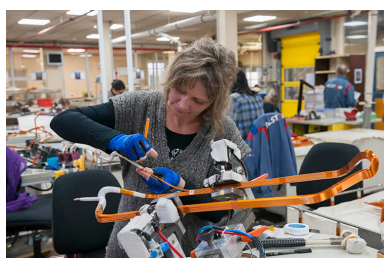
Isolation manuelle des barres de cuivre. Phot. Jérôme Mongreville IVR43_20162500183NUC4A
